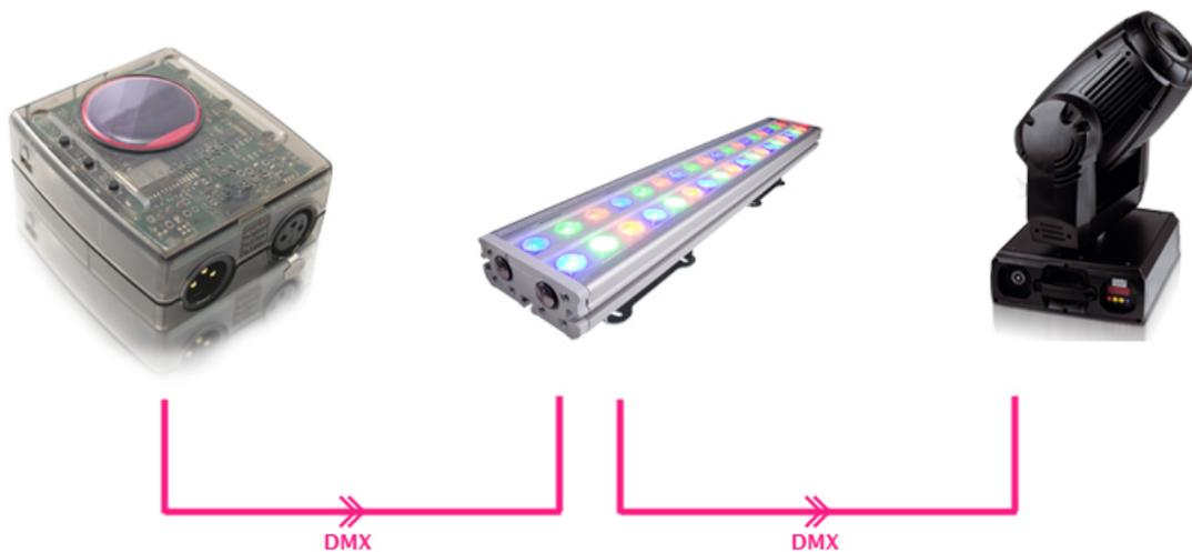
Il y a 512 canaux dans un univers DMX. Chaque projecteur peut être inséré n'importe où entre les canaux 1 et 512. Par exemple une lyre pourra utiliser 6 canaux : X, Y, Intensité, Shutter, Couleur et Gobo.
