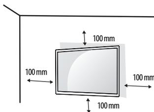
Si vous prévoyez de monter la TV sur un mur, fixez l'interface de montage mural (pièces en option) sur l'arrière du téléviseur.
